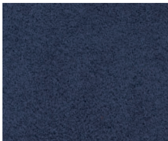
ALCANTARA CHIC GREY Bestell-Nr.: 21 Preisgruppe C 68% Polyester, 32% Polyurethan Scheuertouren: 30.000 Lichtechtheit: 5, Pillbildung: 4 Alcantara Nr. 6404
